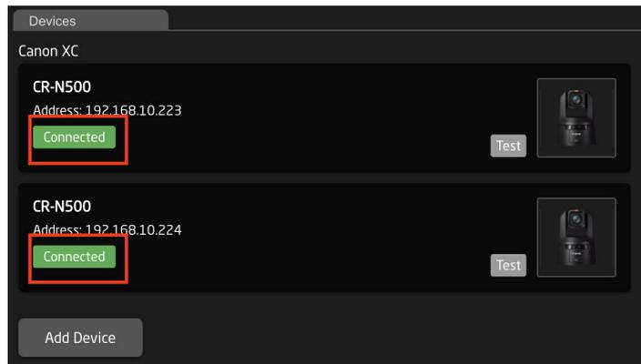
**Devices** セクションでデバイス名をクリックすると、デバイスの詳細が表示されます。ここでは、デバイスの **Name**、**ID**、および **Active Status** を変更できます。デフォルトでは、デバイス名はモデルに一致し、ID は順番に割り当てられ、ステータスはアクティブに設定されています。デバイスが動作するにはアクティブである必要があります。
