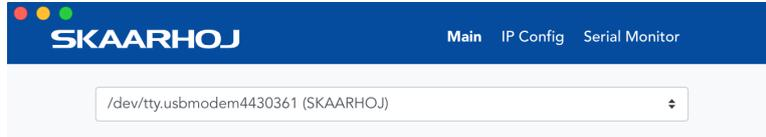
この場合、[/dev/tty.usbmodem4430361](MacOS の場合) として識別され、[IP Config] を押すと IP セットアップページが開きます。
